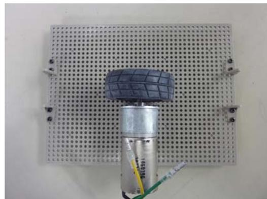
1 2) バッテリーをモーターの背面または反対側にユニバーサルプレート部品やネジを巧く使い保持（脱落しないように）し、プロポの受信機やアンプなども両面テープで固定する。
