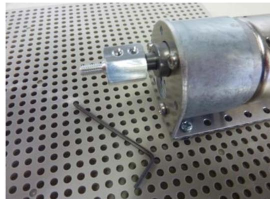
10) 固定したハブシャフトにタイヤを装着（六角形を組み合わせる）し、ネジで固定する。
