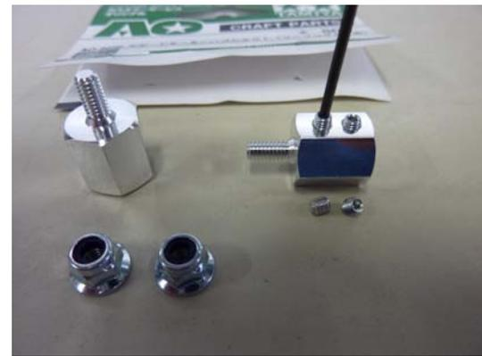
9) このハブシャフトをモーターのギヤヘッド軸に装着する。この時、軸の平らになっている部分にイモネジが当たるように調節し、奥まで入れてしっかりと締める。
