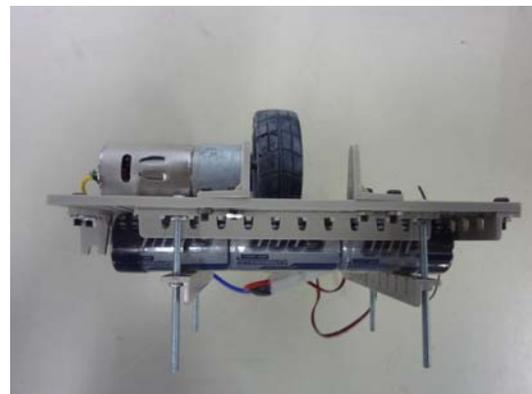
（注意）この基本型ではタイヤの接地面がユニバーサルプレートに当たっているため、テザーを昇降する時に滑り抵抗が大きく、またプレートが削れる恐れがあります。滑りやすい板を貼ることや、穴を開けて反対側にもタイヤを設置させるなど改善が必要です。色々と考えて速くて効率的なクライマーを完成して下さい。なお、25mの高さでは不具合により脱輪すると危険なので、テザーガイドの穴に横棒を通し、テザーから落ちない工夫やタイヤカバーなど安全対策も必要です。
